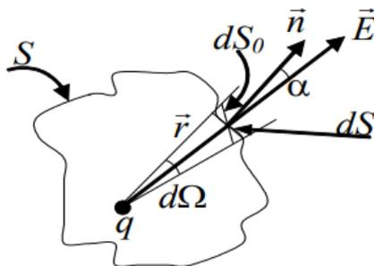
Рисунок 1 – Элементарный поток вектора напряженности
